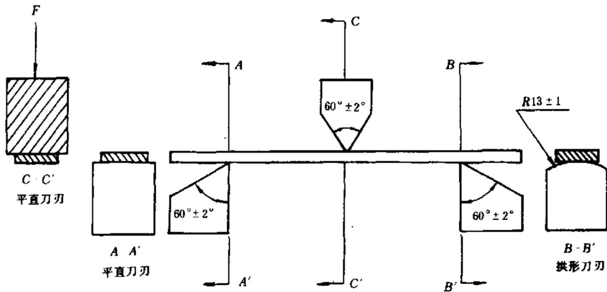
图3 薄板三点弯曲试验示意图
