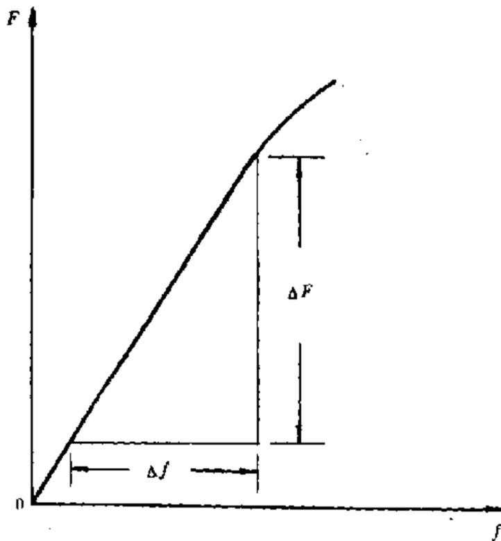
图 5 图解法测定弯曲弹性模量
