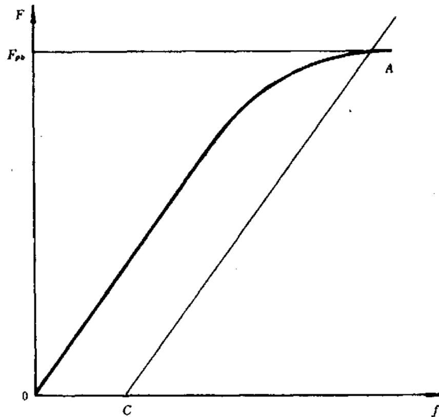
图6 图解法测定规定非比例弯曲应力
