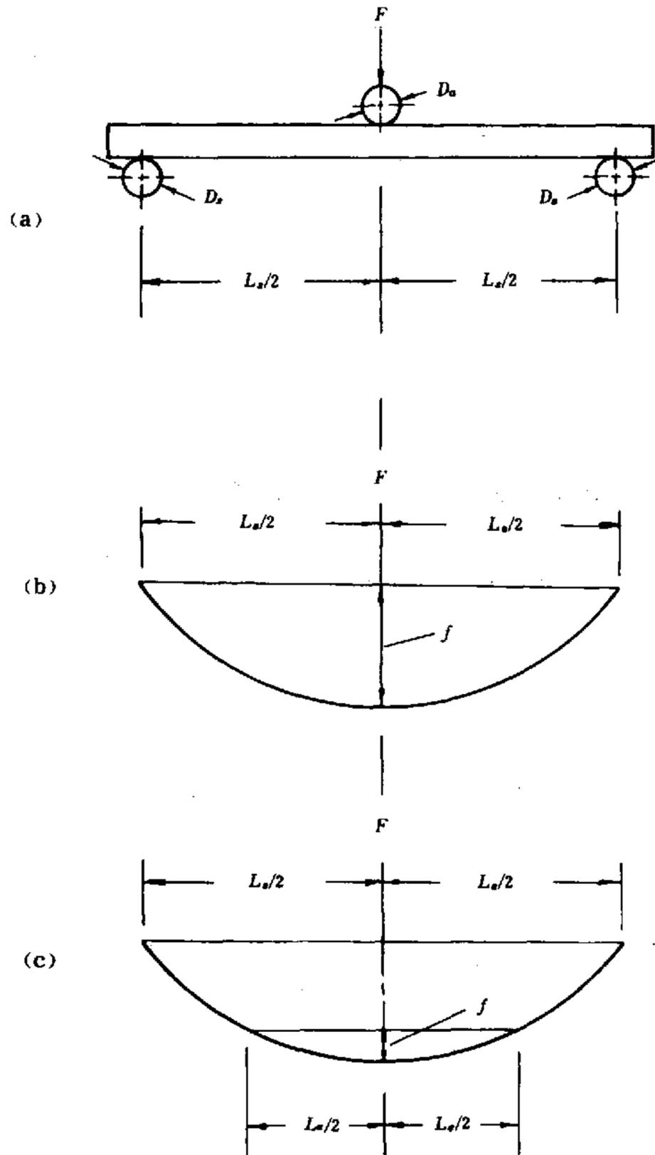
图 1 三点弯曲试验示意图
